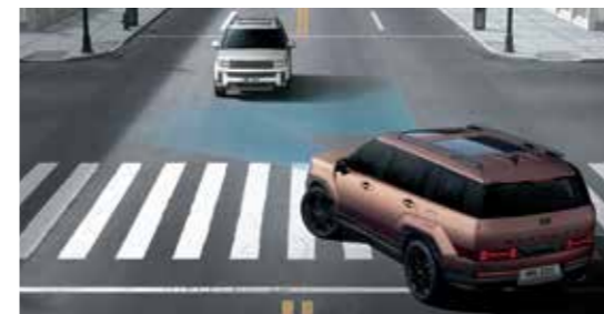
Hỗ trợ phòng tránh va chạm phía trước FCA (hỗ trợ cả khi chuyển làn, rẽ)
